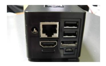
AC アダプター (5V3A:外形5.5mm 内径2.5mm) LAN 10/100/100、HDMI 1080p、System microSD Slot USB2.0x2、eSATA、MicroUSB
