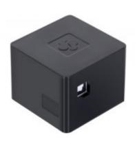
前面パワー LED、irDA 受光部、右側面 Optical 出力端子
