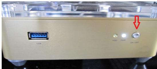
左から USB2.0、HDD アクセス LED、パワー LED、電源スイッチ
