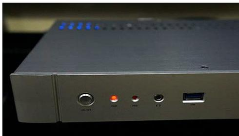
左から、電源スイッチ、パワー LED、SSD アクセス LED、ヘッドホン端子、USB 端子
