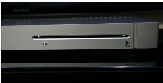
DISC 挿入口および左下取り出しボタン
