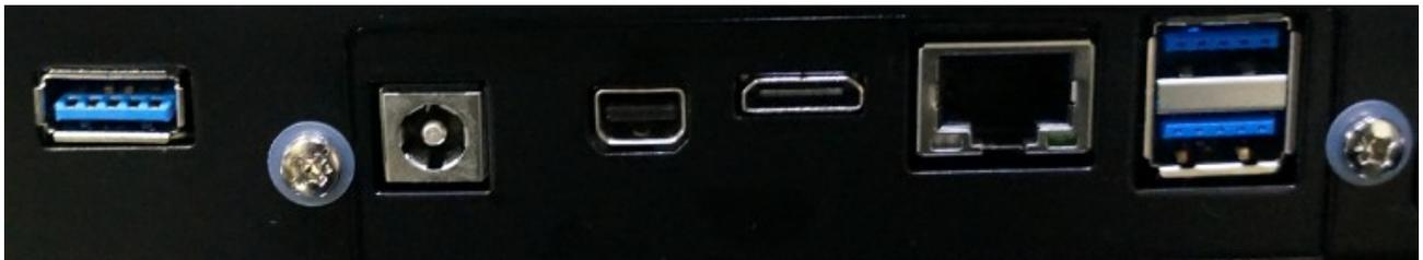
左から USB3.0、AC アダプター、mini Display Port、mini HDMI、LAN、USB3.0x2
